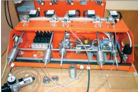
Стенд для испытания стоматологических подшипников
